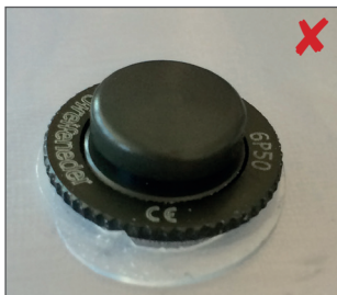
Obr. 2 Spatně fixované ploché těsnění
