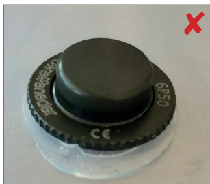
Obr. 2 Spatně fixované ploché těsnění
